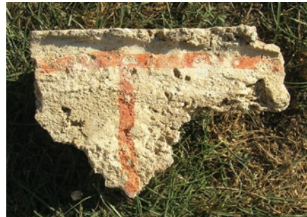
40. kép: A központi torony külső falának vakolattöredéke kváderköves burkolatot imitáló vörös sávossal festéssel
